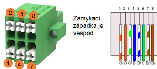
Obr. 2: Konektor systémové komunikace pro HW verzi > 1.1 - vlevo, RJ45 pro HW verzi 1.0 (do roku 2026) - vpravo
